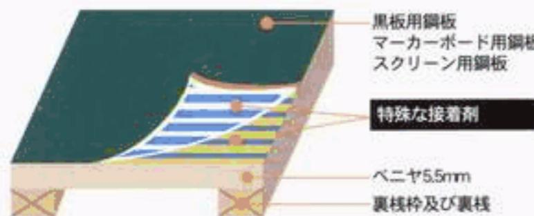
特殊な接着剤で鋼板とペニヤを貼り合わせているため、解体時の分離が難しく、リサイクルへの障壁となっています。
